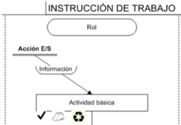
Figura 5 Íconos indicando presencia de requisitos específicos de calidad, seguridad y medio ambiente.
